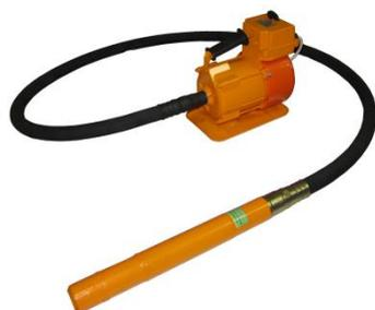
**Вибратор электрический глубинный ручной с гибким валом** и вибронаконечником ВИ-1-17 предназначен для уплотнения бетонных смесей при укладке их в монолитные конструкции с различной степенью армирования, а так же при изготовлении бетонных и железобетонных изделий для сборного строительства. Вибронаконечник имеет планетарный вибрационный механизм. Диаметр вибронаконечника подбирается с учетом расстояния между стержнями арматуры, которое должно быть не менее 1,5 диаметра вибронаконечника.
